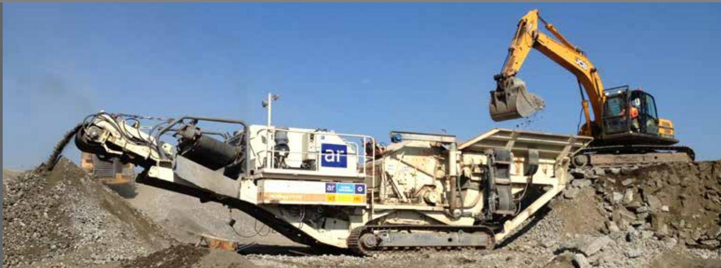
Con grupos móviles de trituración y clasificación automarchantes Voladuras y Demoliciones Chile realiza el reciclaje de los materiales pétreos de la demolición (hormigón y cerámicos) o de la roca procedente de excavaciones.
